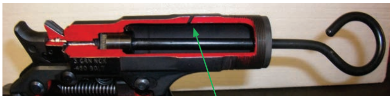
ORIFICIO DE VENTILACIÓN DEL CAÑÓN
