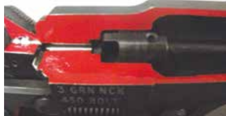
NAHAUFNAHME EINES VERSCHLUSSREINIGERS MIT REINIGUNGSKOPF IN DER KOLBENBOHRUNG
